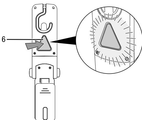
3. Для того чтобы выключить кнопку мигающей сигнальной лампы (6), еще раз нажмите кнопку мигающей сигнальной лампы (6).
